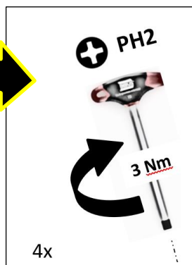
Fig.: 69 : Close the VN301 plus central unit (steps 1 - 4)
