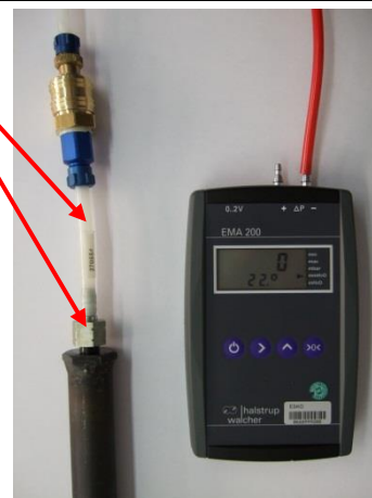
Abbildung 59: Manometer (nicht im Lieferumfang enthalten) an Sammelrohrleitung angeschlossen
