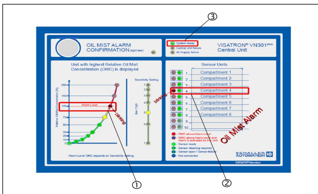
Abb.: 85 : Zentraleinheit VN301plus: Status- Anzeige „Alarm“ bei 100% ÖNK (Bsp.1)
