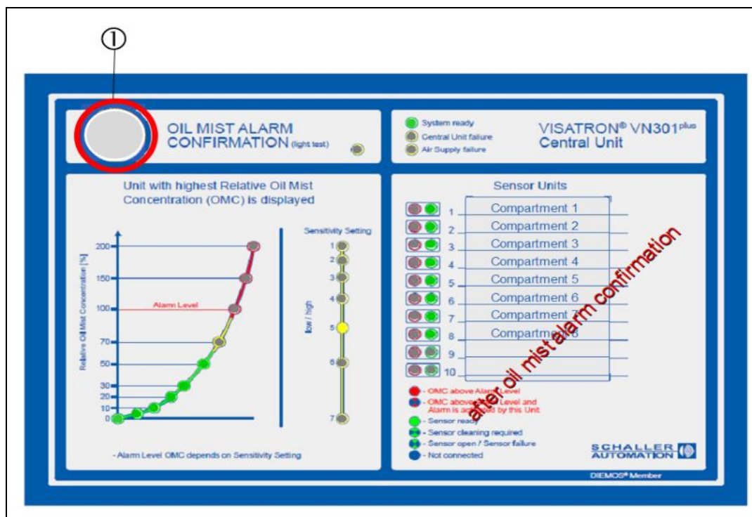
Abb.: 89 :Zentraleinheit VN301 plus : Status- Anzeige nach Bestätigung des Ölnebelalarms
