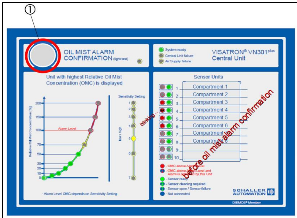
Fig. : 87 : Unité centrale VN301 plus : confirmation de l'alarme de brouillard d'huile (uniquement si < 70 % CBH)
