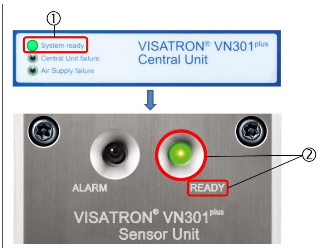
Fig. : 73 : « System ready » sur les unités centrale et de détection VN301 plus / VN301 plus EX
