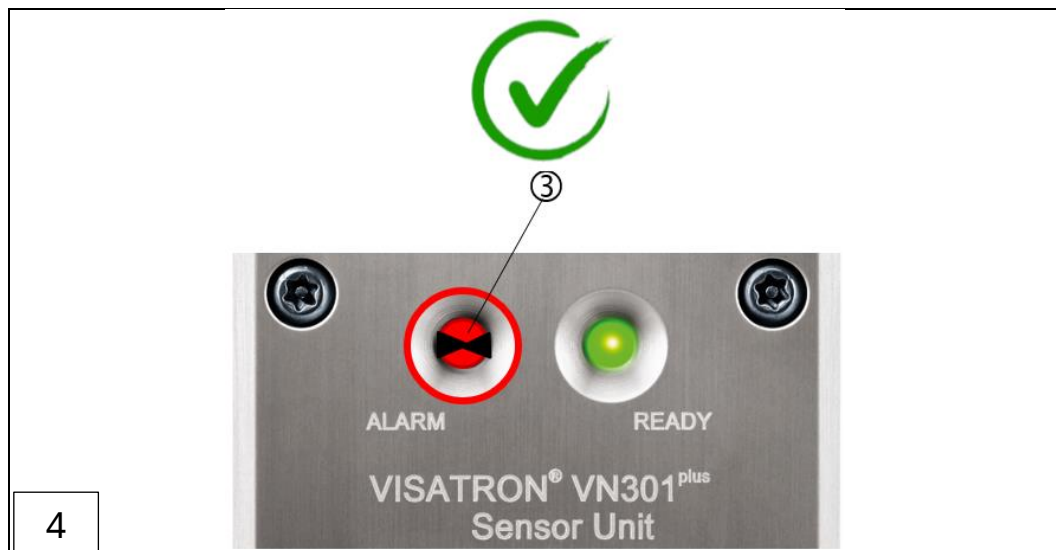
3 : LED rouge qui clignote si le test de fonctionnement est réussi
