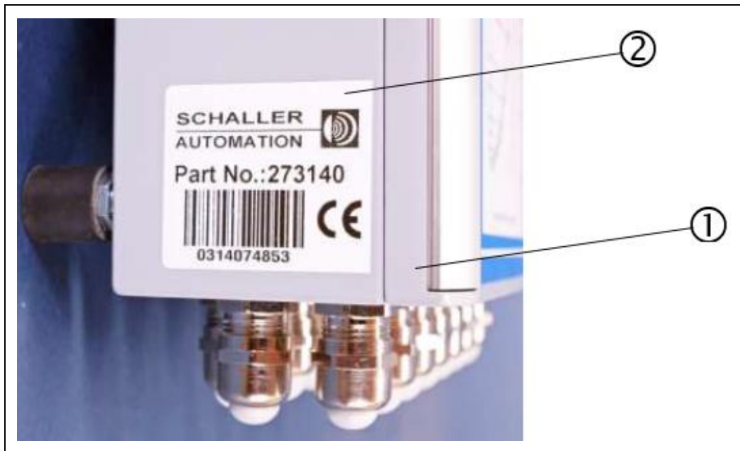
Fig. : 1 : Plaque signalétique sur l'unité centrale VISATRON® VN301 plus
