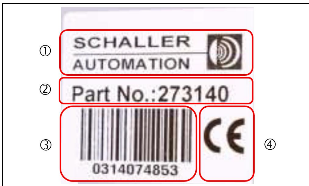
Fig. : 2 : Plaque signalétique sur l'unité centrale VISATRON® VN301 plus
