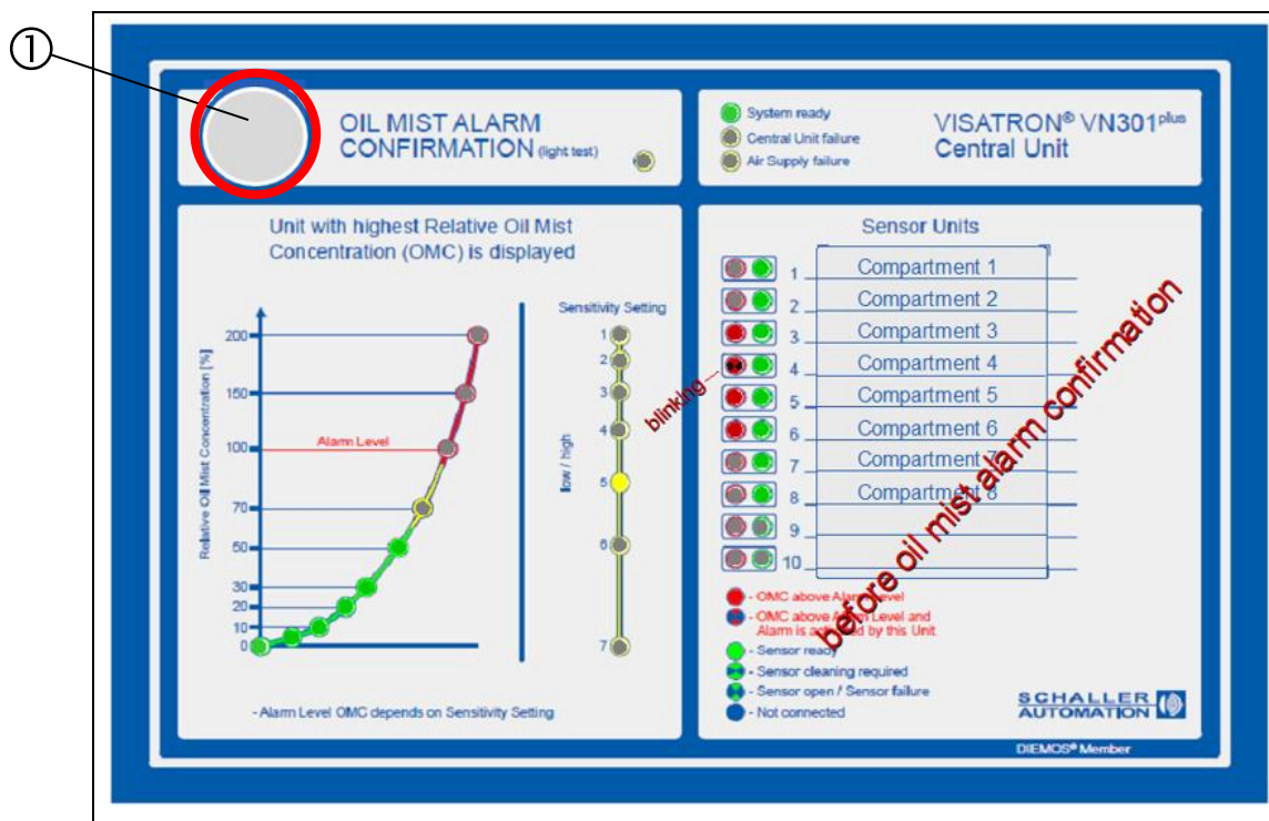
Fig. : 88 : Unité centrale VN301 plus : indicateur d'état « Alarme » à 50 % CBH (exemple)
