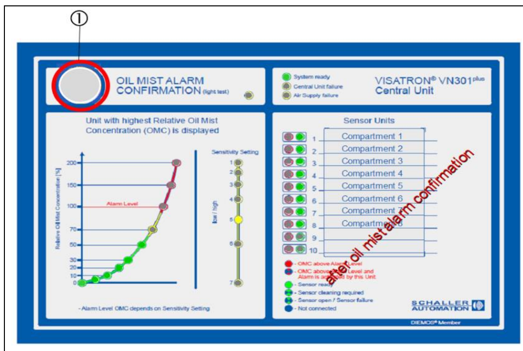
Fig. : 89 : Unité centrale VN301 plus : indicateur d'état après confirmation de l'alarme de brouillard d'huile
