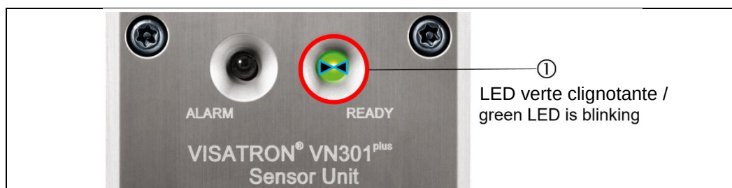
Fig. : 103 : Unité de détection VN301 plus / VN301 plus EX : LED d'état « Ready »
