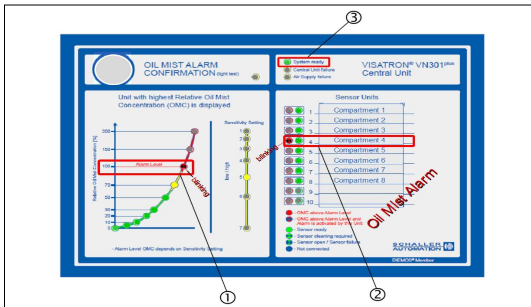
Fig.: 85 : Unità centrale VN301plus: Indicatore di stato "Allarme" al 100 % di OMC (Es.1)
