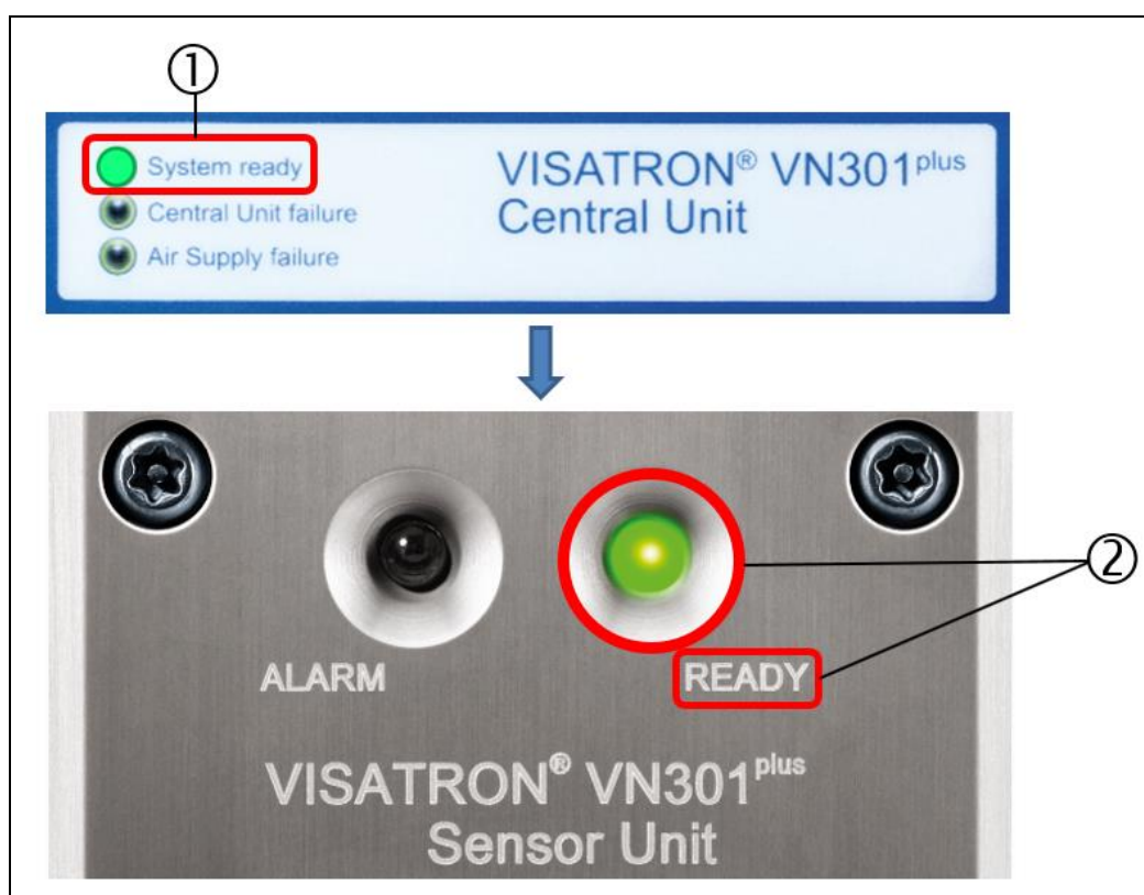
Fig.: 73 : System Ready en la unidad central y la unidad de sensor VN301 plus / VN301 plus EX
