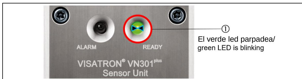
Fig.: 103 : Unidad de sensor VN301 plus / VN301 plus EX: Indicación led de estado «Ready»
