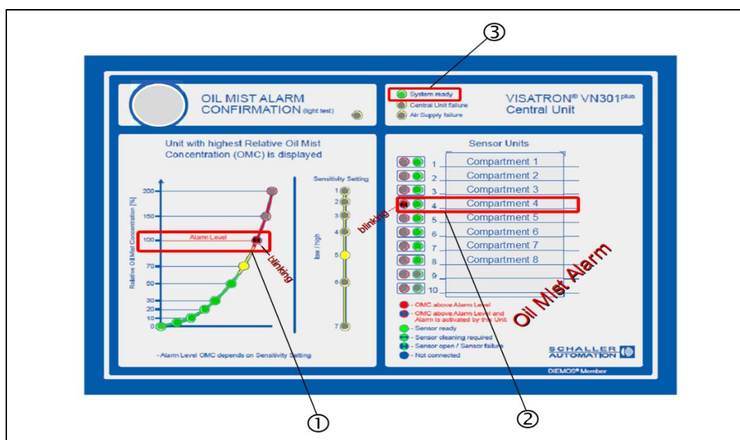
Fig.: 85 : Unidad central VN301plus: Indicación de estado «Alarma» con 100 % de CNA (ejemplo 1)
