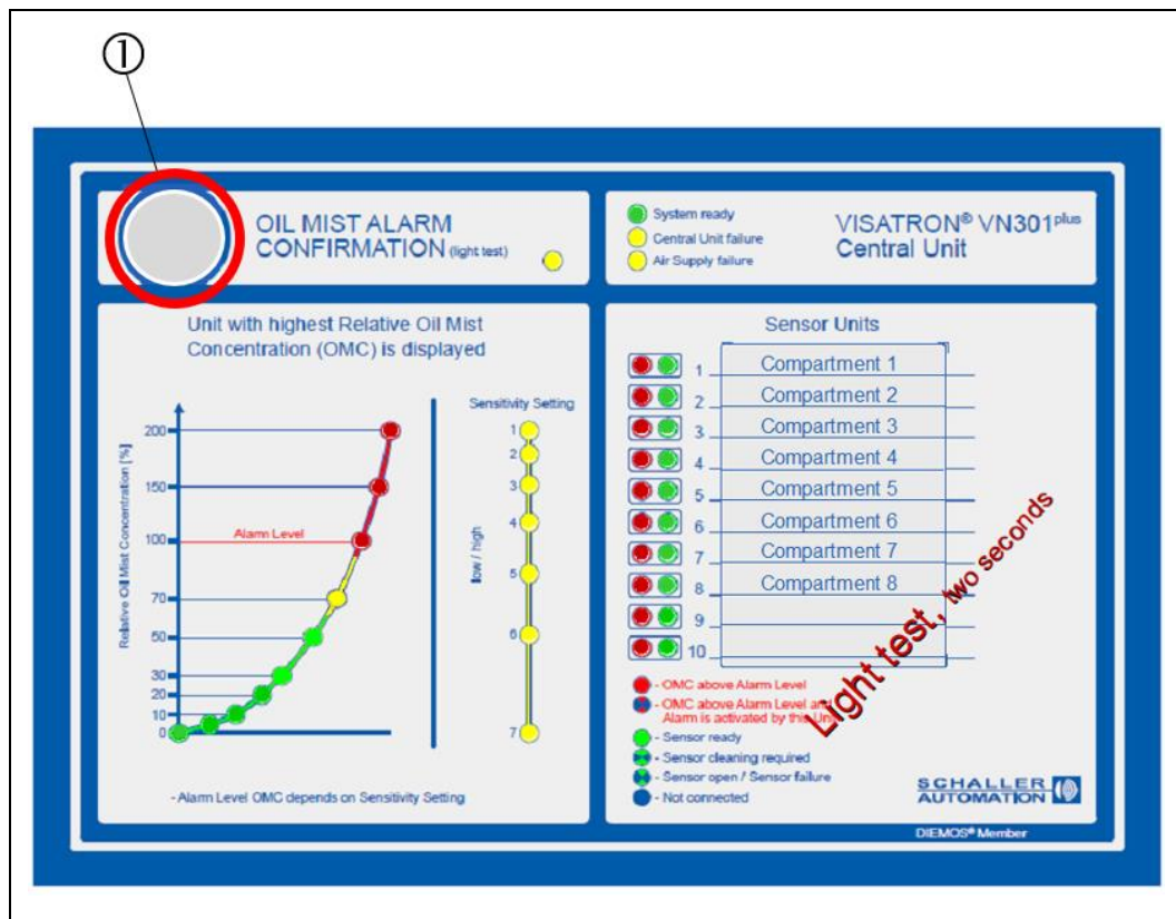
Fig.: 83 : Unidad central VN301 plus : Prueba de led (prueba de luz)
