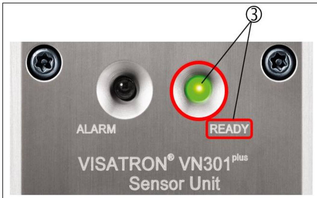
Fig.: 82 : Indicación de estado «Sensor Ready», unidad de sensor VN301 plus / VN301 plus EX
