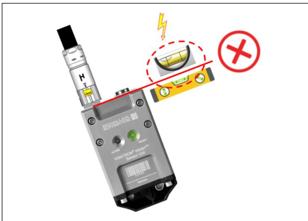
Abb.: 19 : Falsche Montageposition, Sensoreinheit VN301 plus
