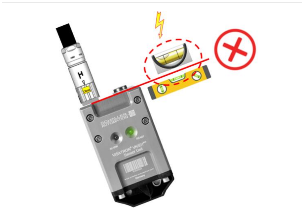
Fig.: 19 : Posizione di montaggio errata, unità sensore VN301 plus
