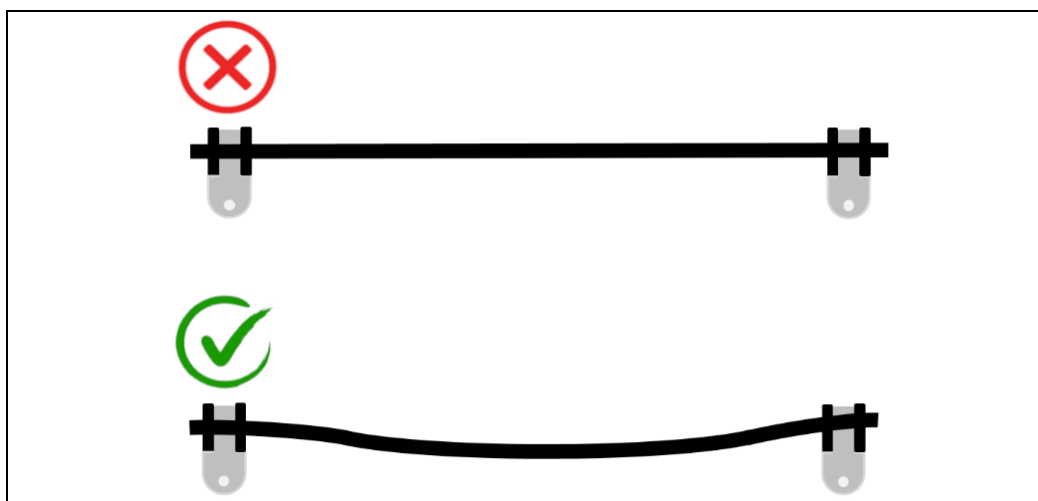
Fig.: 1 : Tendido, cable híbrido
