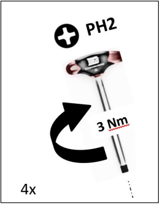
图：11： 锁闭 VN301plus 中央单元（步骤 1-4）
