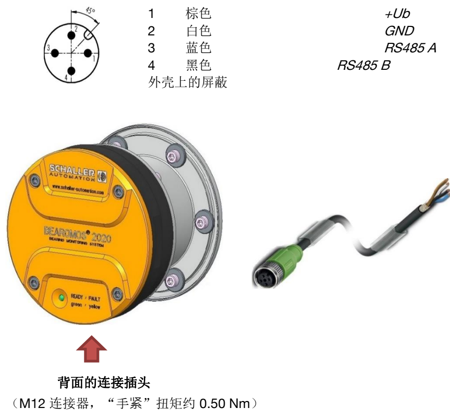
插图 7: 电气连接
