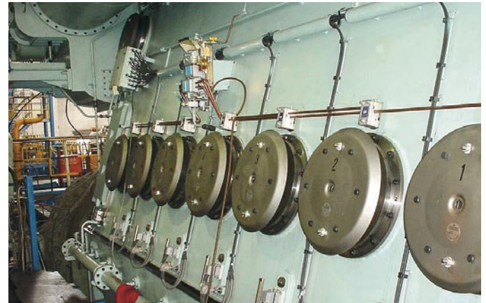
Typische OMD-Installation an einem 2-Takt Motor. Bei neueren Installationen wird das OMD-System bevorzugt auf der anderen Seite des Motors angebaut, weg von den Explosionsschutzklappen
