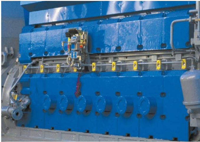
Typische OMD-Installation an einem 4-Takt Motor
