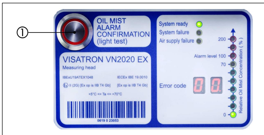
Abb.: 66 : Messaufsatz VN2020: LED- Check (Leuchtestest)
