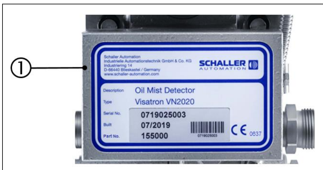
Abb.: 77 :Anschlusskasten, Ölnebeldetektor VN2020
