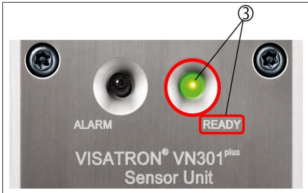
Abb.: 79 : Status- Anzeige „Sensor Ready“, Sensoreinheit VN301 plus / VN301 plus EX
