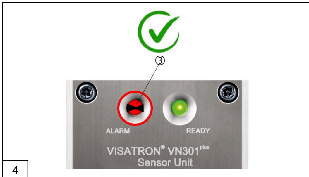
Abb.: 95 : Funktionstest mit Rauchrohr (Nebeltest, Schritte 1-4)
