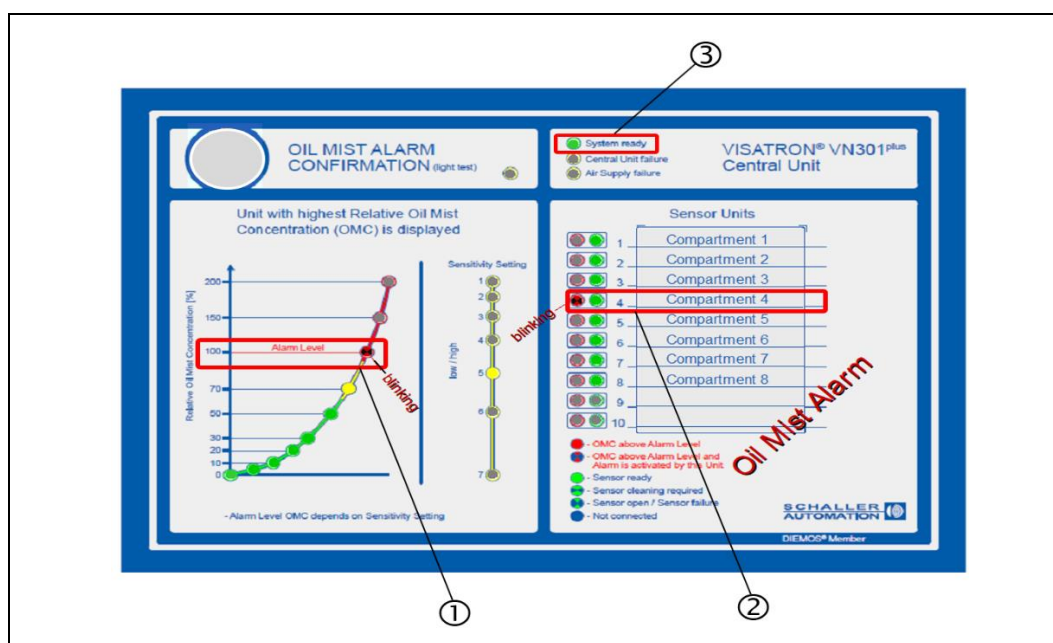
Abb.: 82 :Zentraleinheit VN301plus: Status- Anzeige „Alarm“ bei 100% ÖNK (Bsp.1)
