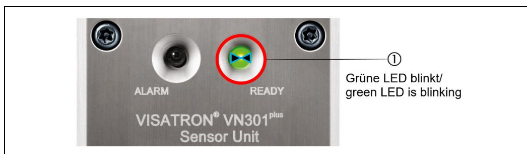
Abb.: 98 : Sensoreinheit VN301 plus / VN301 plus EX: Status- LED Anzeige „Ready“
